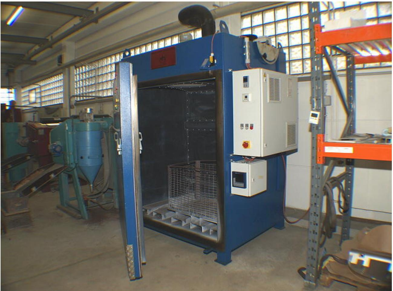
Bild 7 : Temper-Ofen nach dem Stand der Technik, geschlossen dicht mit Steuerung und Absaugung.
