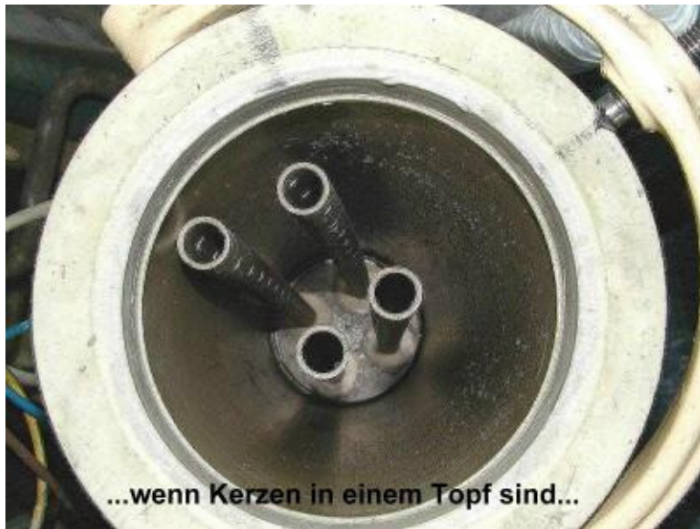
Bild 7: Mehrere Filterkerzen in einem Filtertopf
